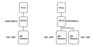
► Drive Capacity: 90[kW] ~ 160[kW]
